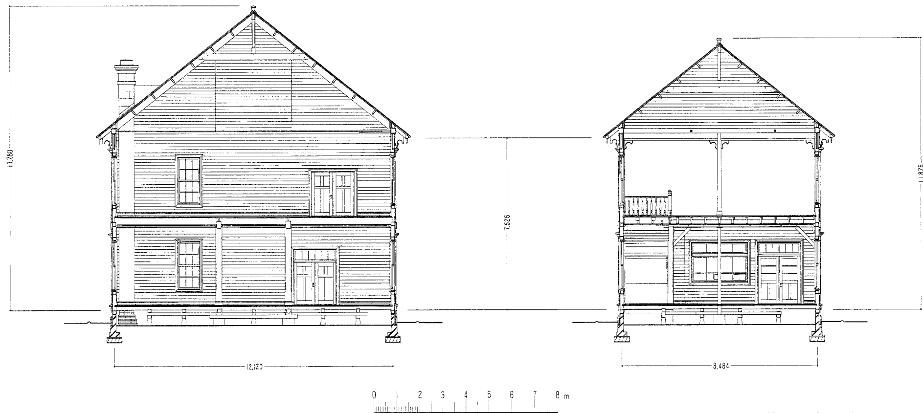
8. 竣工 梁間断面図 (左…本屋、右…翼屋)
